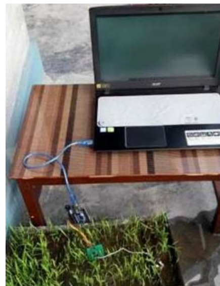
Fig. 3. Checking moisture content using Arduino.
